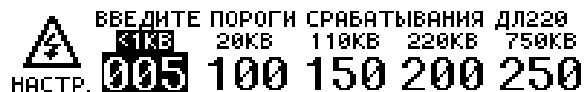
Р и с у н о к 28 — Настройка порогов срабатывания датчика ЛЭП
