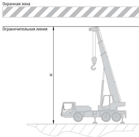
Рисунок 11 — Координатная защита «Потолок»
