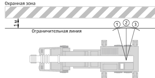
Рисунок 11 — Координатная защита «Стена»
