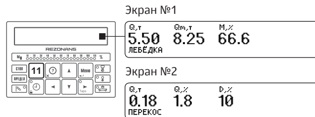
Рисунок 2. Работа крана при контейнерном подъёме
